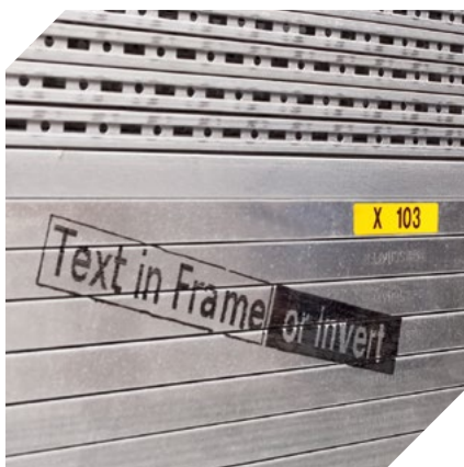
Drukowanie na stosie paneli stalowych czarnym atramentem uniwersalnym.
