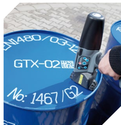
Beczki opisane białym atramentem pigmentowym odpornym na trudne warunki atmosferyczne.
