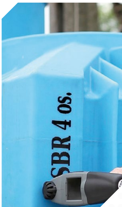
Znakowanie dużych obiektów w terenie atramentami odpornymi na trudne warunki atmosferyczne.
