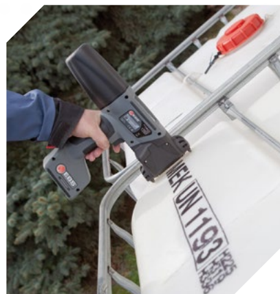
Znakowanie zbiorników wykonanych z PCV, PP, PT i innych tworzyw.
