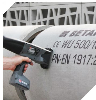
Drukowanie na betonie specjalnym atramentem odpornym na promieniowanie UV.
