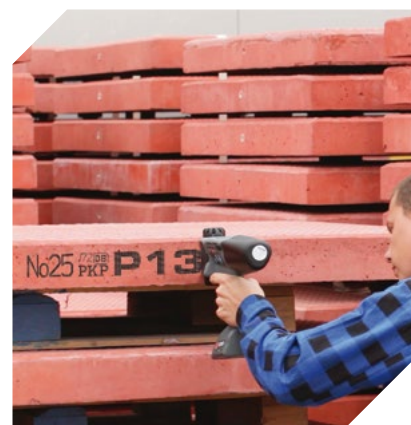
Oznakowanie wąskich prefabrykatów betonowych widoczne z daleka.
