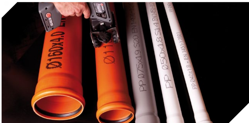
Wykorzystanie rolek do wspomagania znakowania obiektów cylindrycznych (rur, elementów instalacji).
