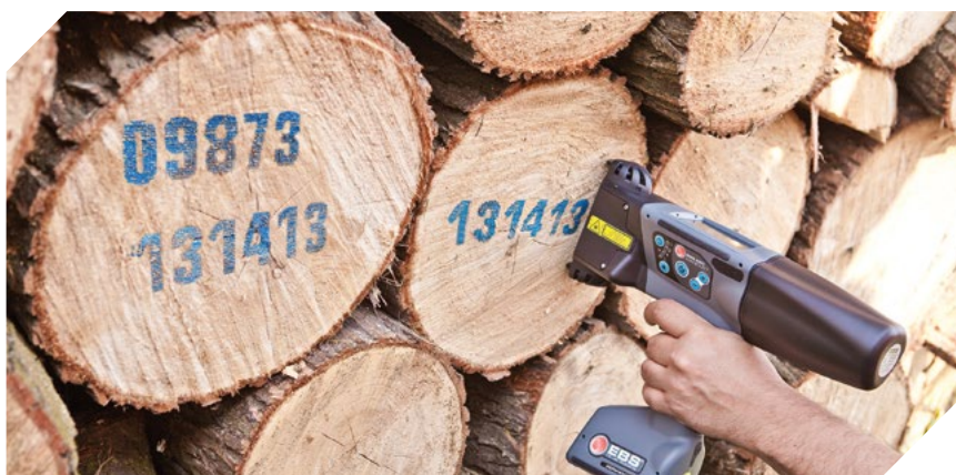
Szybkie znakowanie ściętego drewna w lesie atramentem pigmentowym.
