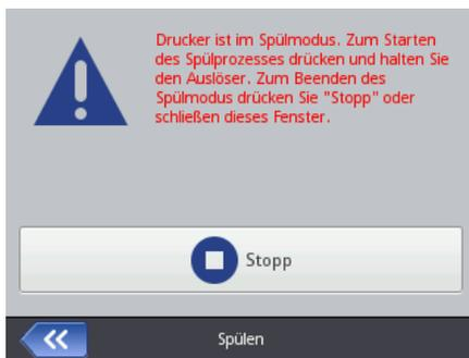
Falls sich im Tintenbehälter Luft angesammelt hat (z.B. durch Eindringen beim Abnehmen und Einsetzen des Tintenbehälters) so soll man das Tintensystem mithilfe der Spülfunktion entlüften. Hierzu stellen Sie den Drucker mit dem Tintenbehälter nach unten und schalten Sie das spülen ein. Halten Sie den Abzug **6** so lange gedrückt, bis aus Düsen Tinte auszulaufen beginnt.
