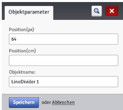
Mit dem Parameter **Position(px)** oder **Position(cm)** bestimmen Sie die Nummer der Vertikalreihe, an der die Trennung des Projektes erfolgen soll. Die Änderung und Ausdruck der geteilten Projekte startet man durch Betätigung des Abzuges **6**.
