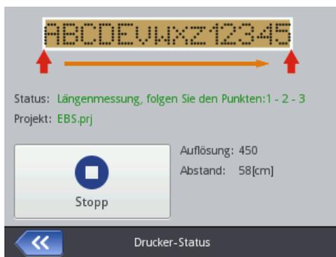
5. Verschieben Sie den Drucker bis zur Stelle, wo der Ausdruck enden soll (die untere Rolle **3** muss ganze Zeit im Kontakt mit der zu bedruckenden Oberfläche bleiben) und betätigen Sie erneut den Abzug **6**.
