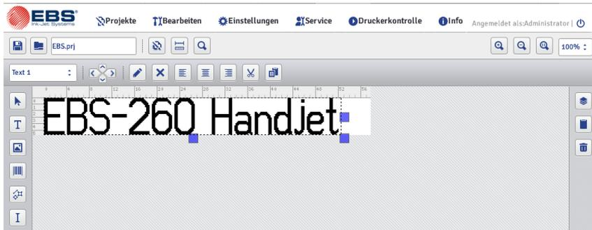
Die Höhe des Editierbereichs ist an den Typ des vorgesehenen Druckkopfes angepasst und entspricht der maximalen Schrifthöhe. Die Breite des Editierbereichs können Sie beliebig modifizieren. Hierzu klicken Sie und halten den Randmarker am rechten Rand des Editierbereichs und verschieben Sie ihn nach rechts oder links. Eine Modifizierung der Breite des Arbeitsbereiches können Sie auch mit der Funktion **Arbeitsfenster** (S. 118) aus dem Menü **Bearbeiten** vornehmen.
