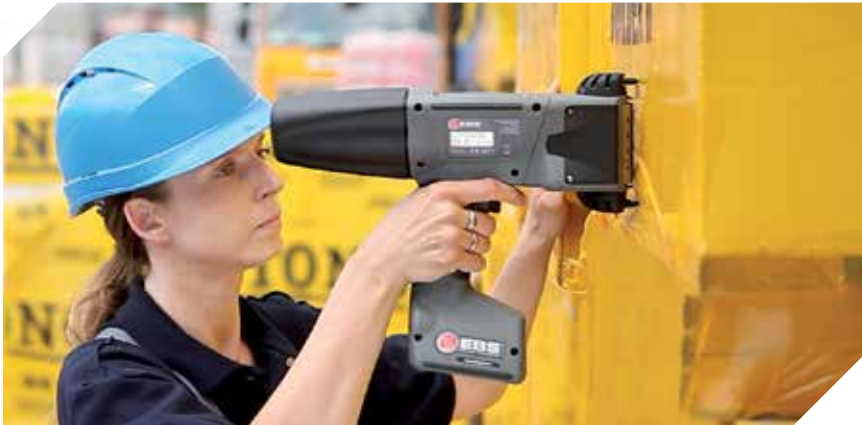
Drukowanie na zafoliowanych materiałach budowlanych.
