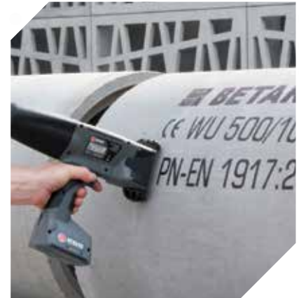
Drukowanie na betonie specjalnym atramentem odpornym na promieniowanie UV.
